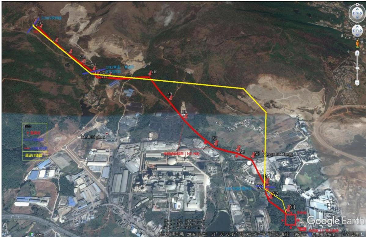
图4-4 110kV弘祥化工输变电工程变更示意图
